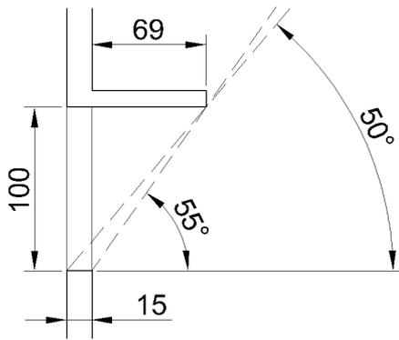
Considere um anteparo horizontal “infinito” de 69 cm de largura, colocado sobre uma abertura com 100 cm de altura, numa parede de 15 cm de espessura, na elevação Leste de uma edificação, na cidade de Montes Claros, conforme corte vertical esquemático ao lado. Considere, também, o período entre os dias 16 de abril e 23 de agosto. A partir de qual horário os raios solares não passam mais pela abertura?
