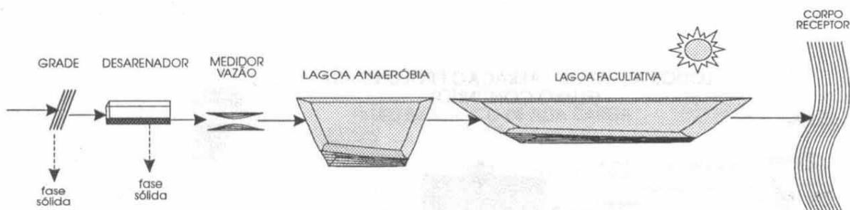
Sabendo que a vazão afluyente para a lagoa anaeróbia é de 600 m<sup>3</sup>/dia, a concentração de DBO afluyente é de 200 mg/L, a eficiência de remoção da DBO da lagoa anaeróbia é de 60,0%, e a taxa de aplicação superficial da lagoa facultativa é de 120 kg DBO / (ha . dia).
