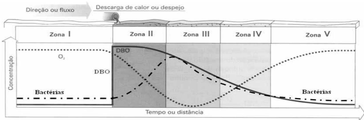
A linha pontilhada representa a concentração de O<sub>2</sub>, a traço-ponto representa a concentração de bactérias e a linha cheia representa a concentração de DBO. (Fonte: Adaptado de BRAGA, Benedito et al. *Introdução à Engenharia Ambiental*. Prentice Hall, 2005)
