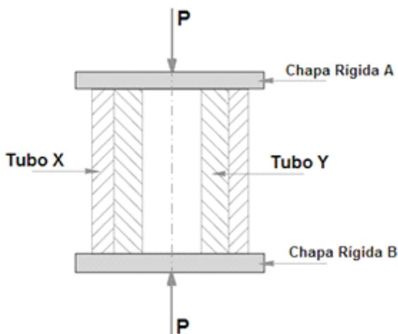
Sabendo que a área da seção transversal resistente do tubo **Y** é igual ao dobro da área da seção transversal resistente do tubo **X** e que o módulo de elasticidade do material do tubo **X** é igual ao dobro do módulo de elasticidade do material do tubo **Y**, é correto afirmar que a intensidade do carregamento de compressão elástico suportado pelo **X** é:
