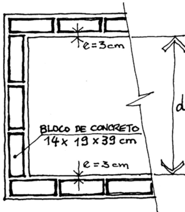
Como se trata de uma cópia entregue ao encarregado, as dimensões no desenho podem estar distorcidas, o que pode trazer problemas para uma solução "visual" na obra. Considerando-se uma execução racionalizada, sem quebra de blocos e com as juntas respeitando as especificações do fabricante, a dimensão 'd' entre as faces acabadas das paredes, em centímetros, indicada no desenho, será de:
