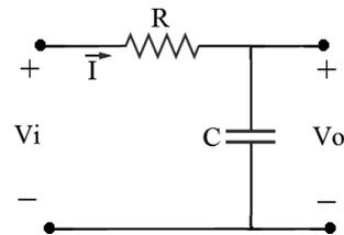
Dados:  $I = 4 \angle 60^\circ$ ;  $C = 200 \mu\text{F}$ ;  $R = 10 \Omega$ ;  $\omega = 10 \text{ krd/s}$ .
