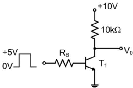
Considerando um Fator de Saturação Forçada de 5, qual o valor aproximado para o resistor de base ( $R_B$ ) para que o conjunto funcione como uma chave ( $V_{BE} = 0,7V$  e  $V_{CEsat} = 0,5V$ ) para o sinal digital da entrada?
