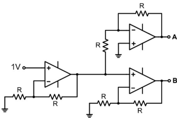
Determine a tensão de saída "V<sub>AB</sub>".
