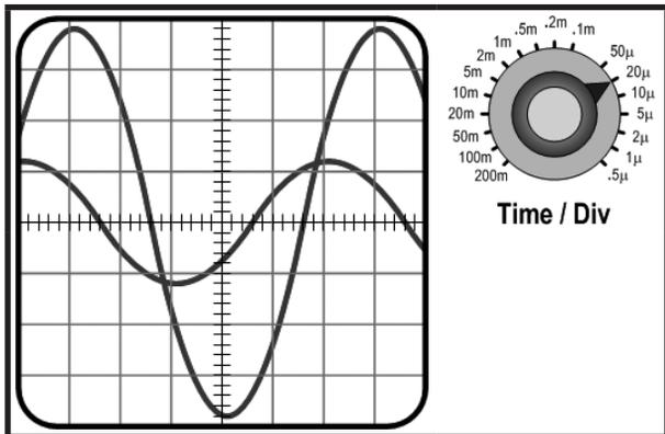
Considerando que os sinais medidos não contêm qualquer tipo de distorção, as escalas de tensão são iguais, qual o valor da defasagem entre os dois sinais medidos?
