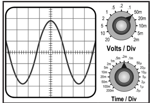
Considerando que o sinal de tensão foi medido nos terminais de um resistor de  $0,56 \Omega$ , não contém qualquer tipo de distorção, não foi acionado qualquer ganho ou atenuação no painel e a ponteira está no modo  $\times 10$ , que alternativa descreve a corrente que passa pelo resistor em questão?
