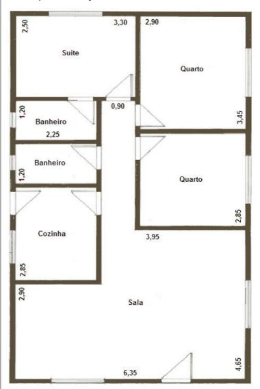
Considere que todas as paredes são de 15 cm de espessura (10 cm do tijolo mais 2,5 cm de revestimento em cada face) e altura interna 280 cm. Despreze os vãos de portas e janelas, bem como a espessura das juntas de argamassa de assentamento do tijolo. Serão utilizados tijolos com dimensões aproximadas de 10 cm x 20 cm x 30 cm. Assinale a quantidade abaixo que mais se aproxima da quantidade de tijolos que será necessária para a execução de todas as paredes.
