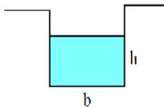
30. A figura ao lado representa um canal de superfície livre, de forma retangular. Se  $b = 48\text{cm}$  e a altura da lâmina d'água é de  $26\text{cm}$ , neste caso o Raio Hidráulico mede, em centímetros
