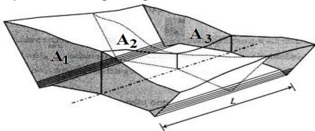
A seção  $A_1$  tem área de  $72\text{m}^2$ , a Seção  $A_3$  tem área de  $92\text{m}^2$  e a seção intermediária ( $A_2$ ), no ponto médio entre  $A_1$  e  $A_3$ , mede  $80\text{m}^2$ . A distância entre os extremos (L), entre  $A_1$  e  $A_3$ , é de 27,00metros.
