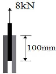
17. Observe a figura ao lado. A figura representa uma estrutura de madeira, formada com três lâminas iguais. A de cor mais escura é intermediária e está colada nas outras duas.
