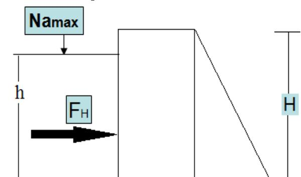
Se a altura "h", que indica a altura máxima do nível de água, é igual 3,20m, o valor de  $F_H$ , componente horizontal (pressão hidrostática) no paramento vertical é, aproximadamente, de
