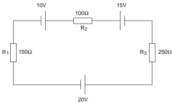
As tensões sobre R1, R2, R3 valem, respectivamente, em volts:
