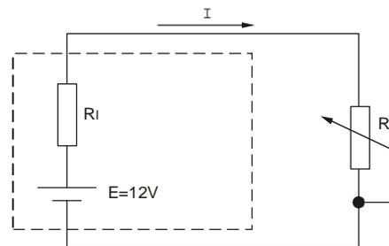
Sabendo-se que a resistência interna da fonte ( $R_i$ ) é igual a  $10\ \Omega$ , variando-se o valor da carga, os valores da máxima potência fornecida pela fonte à carga e da corrente  $I$  nesta situação, são iguais a:
