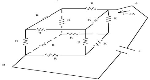
**2** Observe o circuito abaixo e determine as correntes  $i_1$ ,  $i_2$  e  $i_3$ , para  $R_1$  =  $2\Omega$ ,  $R_2$  =  $3\Omega$  e  $R_3$  =  $5\Omega$ .
