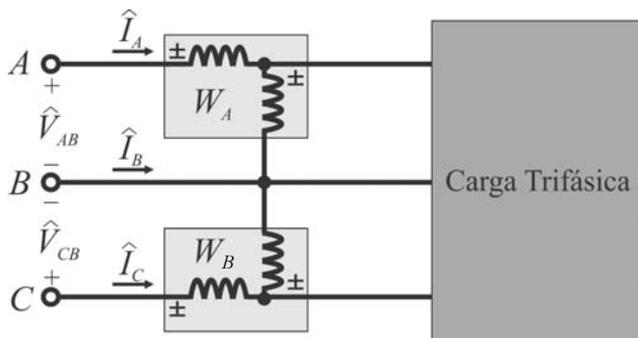
A figura acima ilustra o esquema de medição de potência de uma carga trifásica pelo método dos dois wattímetros. Assinale a opção correta, considerando que as medições dos wattímetros  $W_A$  e  $W_B$  sejam, respectivamente, iguais a  $50\sqrt{3}$  W e  $150\sqrt{3}$  W.
