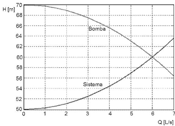
A figura acima mostra as curvas do sistema e da bomba de um sistema de bombeamento de água, em que se considera o peso específico da água  $\gamma = 1.000 \text{ kg/m}^3$ . Considerando o ponto de operação do sistema e que o seu rendimento total seja de 80%, julgue os itens que se seguem.
