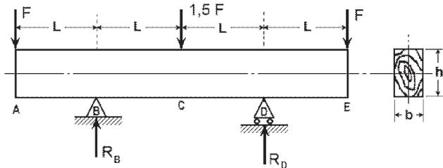
O carregamento mostrado na figura acima consiste em uma viga de madeira biapoiada, de área de seção  $h \times b$  e comprimento  $4L$ . Com relação a essa viga, julgue os itens seguintes.
