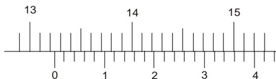
A medida refere-se ao diâmetro do assentamento de um dos rolamentos na caixa, correspondendo, em mm, ao valor de
