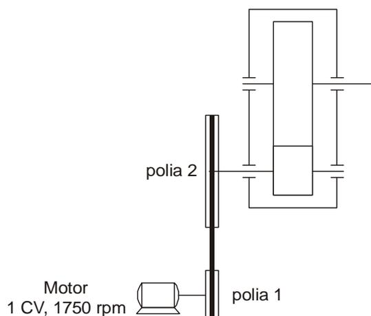
Como o máximo torque exigido na saída é de 15 Nm e os componentes suportam esse incremento de rotação, a adaptação mais simples será
