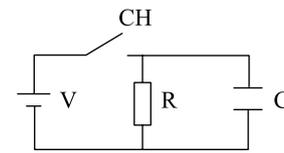
Supondo que a chave CH é aberta no instante  $t_1$ , no qual o capacitor está plenamente carregado, a forma de onda que pode ser vista entre os pinos do capacitor deve apresentar a configuração:
