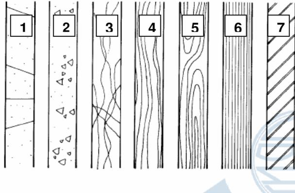
Conforme estabelecido pela ABNT — NBR 6492/1994, os materiais mais usados possuem convenções que, conforme figura no destaque (em ordem numérica), correspondem a
