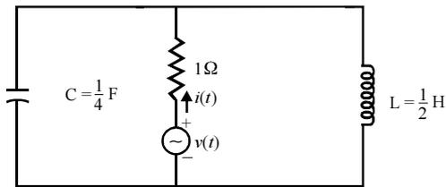
Considerando que o circuito mostrado na figura acima opere em regime permanente alimentado por tensão senoidal  $v(t) = 10\text{sen}(2t)$ , em V, julgue os itens subsequentes.
