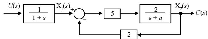
Com base no diagrama de blocos na figura acima, que representa um processo físico cuja entrada é  $U(s)$  e saída  $C(s)$ , e considerando que  $s$  seja o operador complexo da transformada de Laplace, julgue os itens a seguir.
