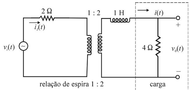
O circuito elétrico mostrado na figura acima é alimentado por uma fonte de tensão senoidal, cuja tensão instantânea é  $v_s(t) = 10\sqrt{2}\text{sen}(16t)\text{V}$ . Considerando que o transformador seja ideal e que o circuito elétrico esteja funcionando em regime permanente, julgue os itens a seguir.
