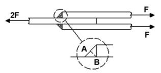
O valor da tensão de cisalhamento média  $(t_{AB})$  neste plano é (Considere todas as chapas com espessura H e submetidas a forças de tração F)
