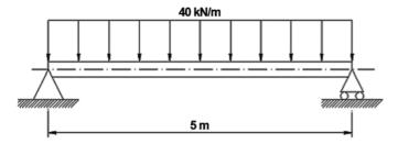
Sabendo-se que o comprimento da viga é igual a 5 m, o valor do momento fletor máximo, em kN.m, é
