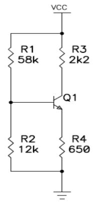
Sabe-se que os valores dos resistores são dados em Ohms, Vcc = 10 V, hfe=200 e que a tensão  $V_{\text{BE}}$  quando Q1 está na região ativa é de 0,7 V. Nessas condições, a tensão no coletor em relação ao terra ( $V_{\text{C}}$ ) é de, aproximadamente,
