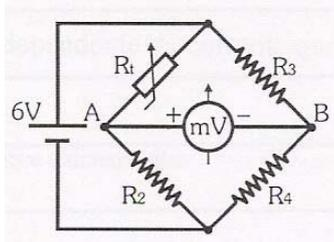
Nessas condições, os valores de tensão na ponte para cada um dos valores de temperatura são, respectivamente,
