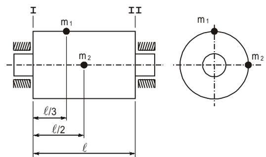
Pretende-se balancear o rotor com a adição de uma única massa em cada um dos planos laterais. Para tanto, no plano I deve-se colocar uma massa
