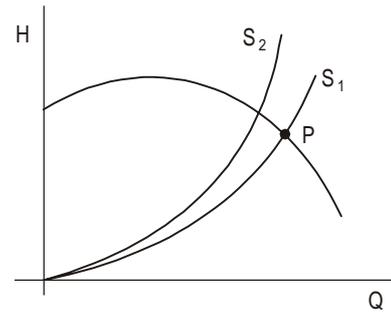
Modificações no projeto deslocaram a curva  $S_1$  para a situação  $S_2$ . Sendo inviável substituir a instalação, algumas sugestões foram dadas para restabelecer a vazão prevista inicialmente. A hipótese prontamente descartada foi a de
