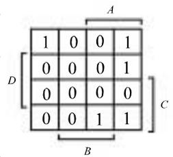
80 A expressão mínima, na forma de soma de produtos, para a função lógica de saída do circuito representada pela tabela mostrada é  $A\bar{B}\bar{C} + \bar{B}\bar{C}\bar{D} + A\bar{C}\bar{D}$ .
