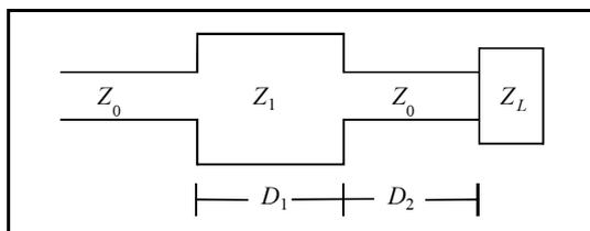
A figura acima mostra uma seção de linha de transmissão de impedância característica  $Z_1$  utilizada para realizar o casamento entre uma carga  $Z_L$  e uma linha de transmissão de impedância característica  $Z_0$  real. Considerando essa figura, julgue o item abaixo.
