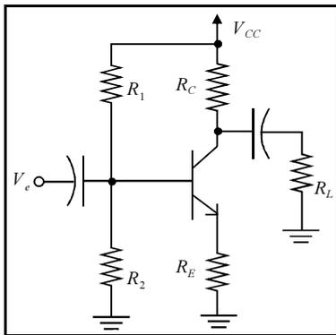
A figura acima mostra o esquemático de um amplificador a transistor. Nesse amplificador, considere que o transistor esteja corretamente polarizado na região ativa e que os capacitores, por terem valores de capacitância muito altos, comportam-se como curtos-circuitos na faixa de frequência de passagem do sinal. A respeito desse amplificador, julgue os itens a seguir.
