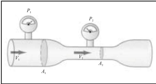
Um perito foi designado para analisar as tubulações por onde flui um gás inflamável considerado ideal. A tubulação rompeu-se, provocando um incêndio em um *shopping*. A polícia trabalha com a hipótese de incêndio criminoso. A tubulação original tinha uma área seccional  $A_1$  constante, em toda a sua extensão. A tubulação sofreu modificações no seu diâmetro, como mostra a figura acima, onde  $A_2 = \frac{A_1}{2}$ .
