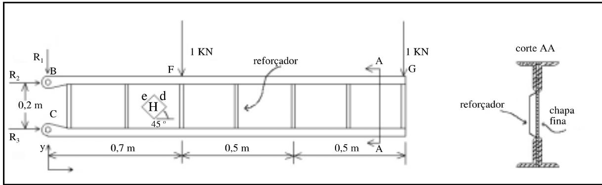
A figura acima mostra uma longarina construída a partir de quatro cantoneiras rebitadas em uma chapa fina. Entre as cantoneiras, são rebitados reforçadores feitos de chapa dobrada em Z. A longarina é fixada à fuselagem por meio de dois pinos nas posições indicadas por B e C.
