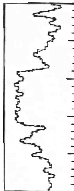
Na figura acima, a seção total perfilada equivale a 1.250 m — a escala vertical unitária representa 50 m de espessura de seção sedimentar —, indicando um poço a partir de 1.000 m. A seção é representada por rochas terrígenas.
